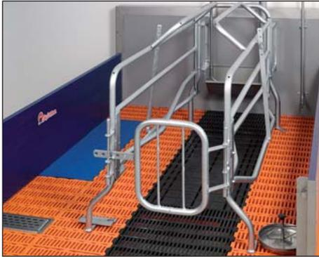
4-Fußbucht mit Gußrost unter der Sau und integrierter Kunststoff-Heizplatte für die Ferkel
