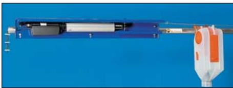
Automatische Auslösestation – kann bis zu 100 Volumendosierer gleichzeitig auslösen
