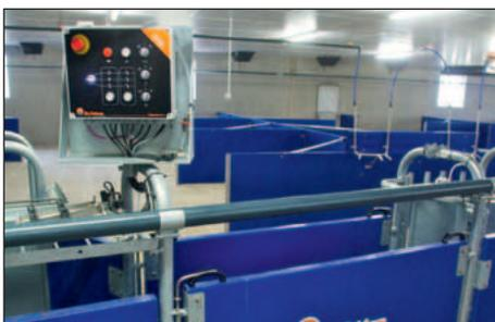
Möglichkeit der manuellen Bedienung an der Station
