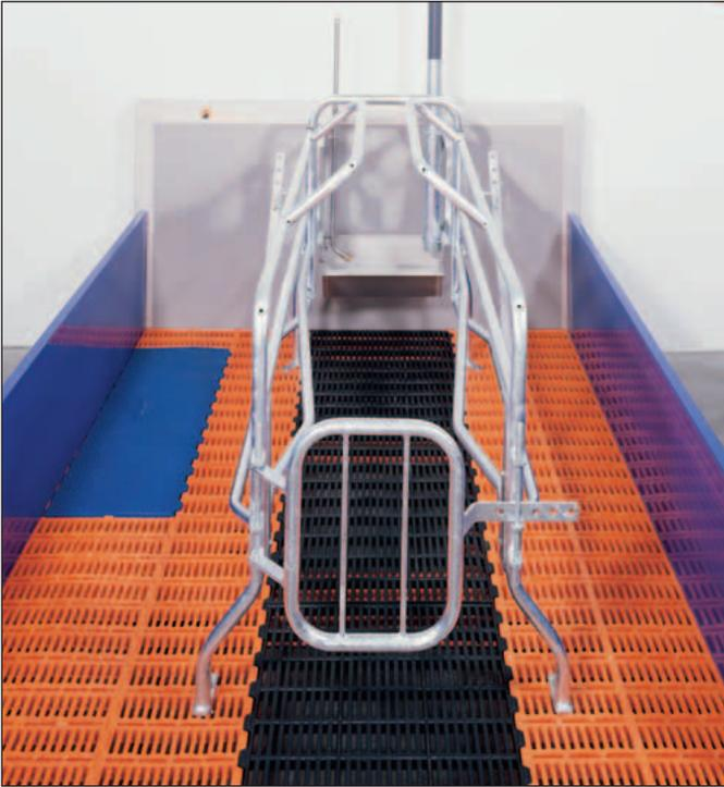
Abferkelbucht mit einer Liegefläche für die Sau aus Gußrosten und integrierter Kunststoff-Heizplatte
