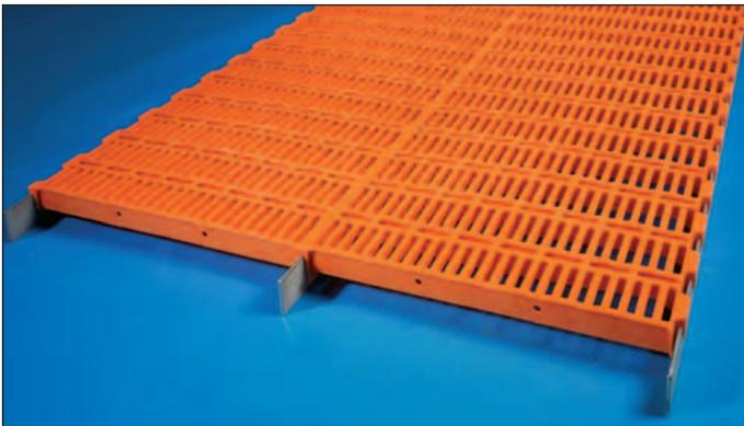
Die Montage ist denkbar einfach und geht schnell von der Hand. Pro Quadratmeter werden ca. 2,5 m Flächeisen benötigt. Alle Kunststoff-Roste können außerdem auf Maß geschnitten werden. Im Bedarfsfall ist ein Aufnehmen der Roste auch nach dem Verlegen unkompliziert möglich.
