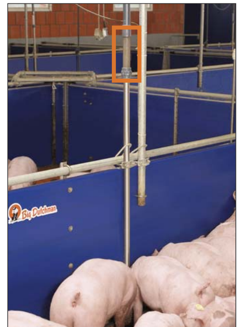
Durchsichtiges Rohr zur Kontrolle des Futterflusses
