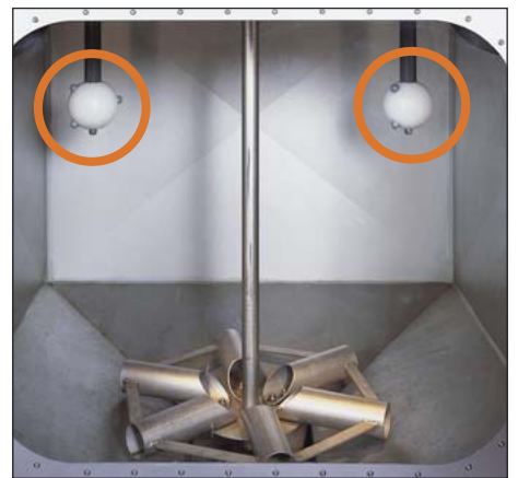
Tankreinigung mittels rotierender Reinigungsköpfe
