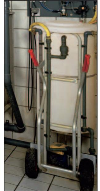
Das MediSystem ist mit einer mobilen Pump- und Anmischstation ausgerüstet, die für mehrere Ställe eingesetzt werden kann.
