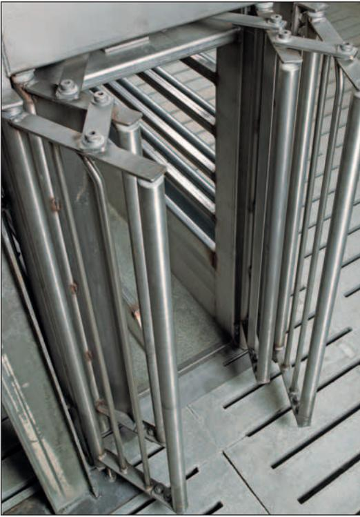
Der Eingangsbereich der Waage besteht aus einem inneren und einem äußeren Tor. Das innere Tor gehört zur Wiegeeinheit, die stabil am Grundrahmen hängt. Zwei oben angebrachte Wiegezellen sorgen für eine sichere Gewichtsermittlung. Das äußere Tor schützt die Wiegeeinheit vor Gewichtverfälschungen durch andere Tiere und sorgt so für eine sehr genaue Wiegung. Die Wiegeeinheit selbst ist mit einem rutschfesten Boden ausgestattet => sicherer Stand in der Waage.
